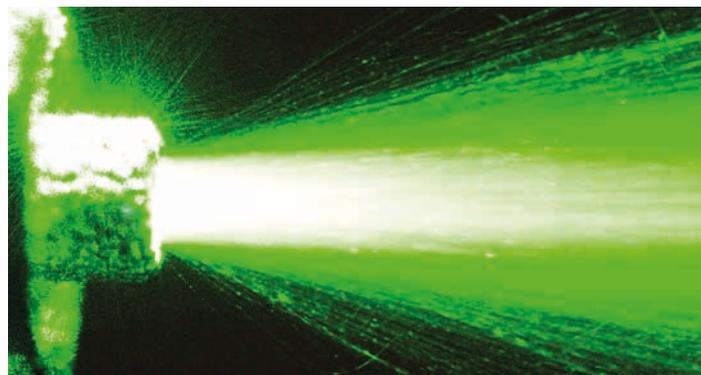
Ein Pulverstrahlgerät gibt das Pulver an der Austrittsöffnung in einem unkontrolliert großen Winkel ab, was verminderte Effizienz und erhöhte Spritzerbildung zur Folge hat.
