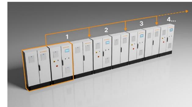
Falls der maximale Bedarf an Dampf nicht von einem einzigen Dampferzeuger gedeckt werden kann oder eine störungsfreie Dampfversorgung durch Redundanz gewährleistet werden soll, kann die Anlagenkapazität beliebig erweitert werden. Hierbei werden mehrere Dampferzeuger parallel angeordnet und am Dampfausgang zusammengeführt.
