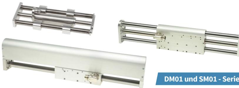
Linearmodule mit Schutzklasse IP64S und Edelstahl-Linearmodule mit Schutzklasse IP69 bestehend aus Linearführung und fest integriertem LinMot Linearmotor. Optional mit der magnetischen Feder MagSpring® und einer pneumatischen Haltebremse ausgestattet. Die Antriebe bieten Hublängen bis 680 mm und eine Spitzenkraft bis zu 572 N.
