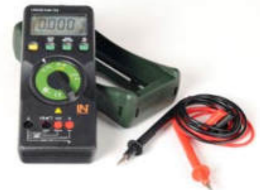
Multimeter mit optischer Daten-Schnittstelle zur Anzeige des Displays über ein virtuelles Instrument auf dem PC.
