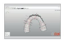
Setzen Sie in der Software Sägeschnitte und Pinlöcher, die automatisch im 3D-Druckprozess umgesetzt werden.
