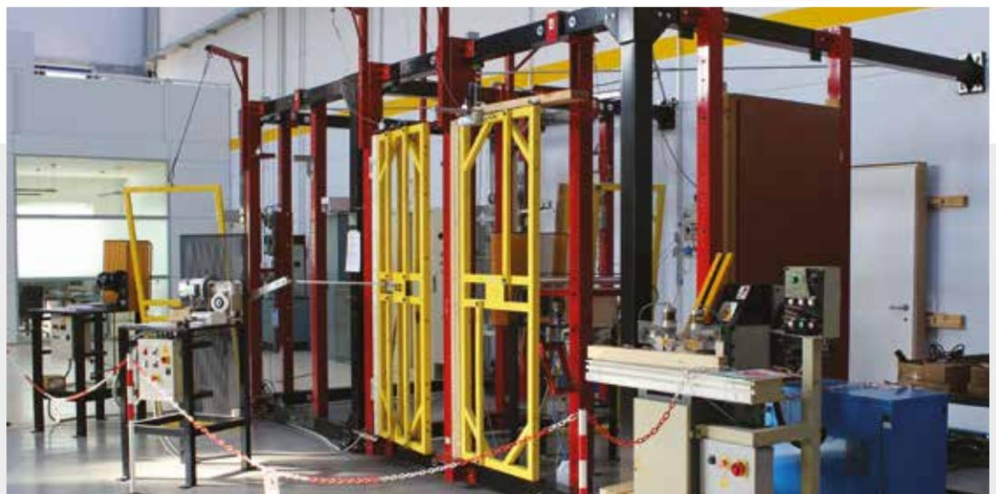
Sicht der I.U.S OTLAV Test Laboratorien (Simulator von intensiver Nutzung)
