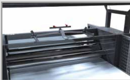
AC2 - AUTO GLUE FEEDING SYSTEM AC2 - SISTEMA DI ALIMENTAZIONE AUTOMATICA COLLA
