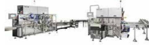
Multipacks liegen im Trend. Kleine Tafeln, dicht verpackt. Aber im klassischen Falteinschlag, damit die Premiumoptik stimmt. Die kompakte Anlage zur Verpackung von kleinen Schokoladentafeln in Multipacks bietet einen hohen Output bei optimalen Produktschutz. Die RCB-HS übernimmt die dicht gesiegelte Primärverpackung, unsere CML die Kartonierung.
