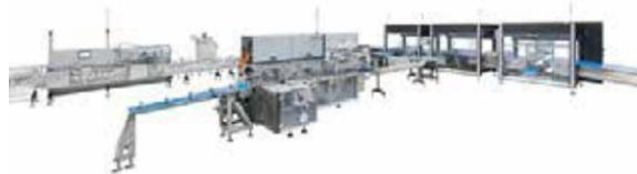
Maximale Format- und Packmittelvielfalt. Ob Riegel oder Tafel, ob dichter Schlauchbeutel oder klassischer Falteinschlag. Die Anlage zur Verpackung von Schokolade bietet maximale Flexibilität und Variabilität. Die LOMATIC-Stationen verteilen die Produkte zuverlässig auf die Packmaschinen. LTM-DUO oder FHW-S übernehmen effizient die Verpackung.
