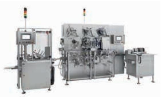
Die Linienkombination besteht aus der Falteinschlagmaschine GWS-M zur Verpackung von Kaugummieinzelstreifen in aluminiumkaschierte Folie und Banderole mit anschließender Gruppierung und Herstellung eines klassischen Kaugummipäckchens. Um einen verkaufsfertigen Displaykarton zu erzeugen, erfolgt die direkte Anbindung an einen Sammelkartonierer. Ihre Systemlösung: unsere kompakte Einstiegsvariante im mittleren Leistungsbereich.
