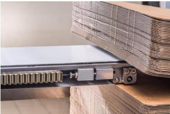
Clever gelöst: In das neu konzipierte Vertikalmagazin passen Zuschnitte unterschiedlichster Größen.
