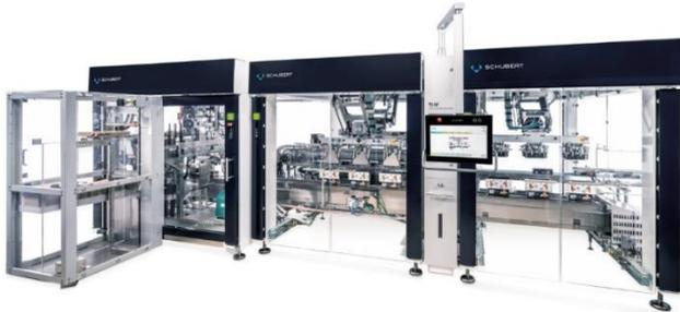
Kompakte Lösung: Das neue Vertikalmagazin, einbahniges Aufrichten und weniger Roboteraggregate bedeuten mehr Flexibilität und ein kostengünstiges Maschinendesign.
