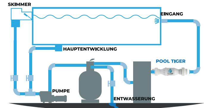
Wenn die Rücklaufleitung zu kurz ist, um den PoolTiger® in Reihe zu installieren, muss ein Bypass eingerichtet werden. Pool Tiger® kann horizontal, vertikal oder diagonal installiert werden.
