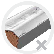
Rissbildung an den Abdrücken des Crimpstempels
