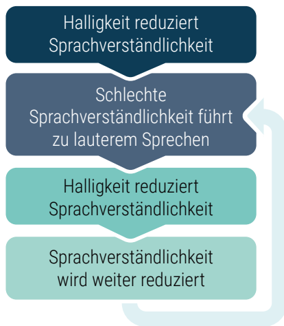
Abb. 1.7: Lombard-Effekt (eigene Darstellung in Anlehnung an Metzen [3]) und Raumakustischer Effekt (eigene Darstellung in Anlehnung an Fraunhofer IBP [61]).
