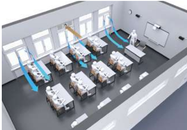
Abb. 2.4: Ein Abluftventilator kann die Nachströmung der Außenluft durch gekippte Fenster unterstützen. Ist die eintretende Luft kühler als die Raumluft, entsteht eine aufsteigende Verdrängung der Raumluft, die der Ventilator im oberen Raumbereich absaugt (Abbildung von Kampmann GmbH & Co. KG aus [5]).
