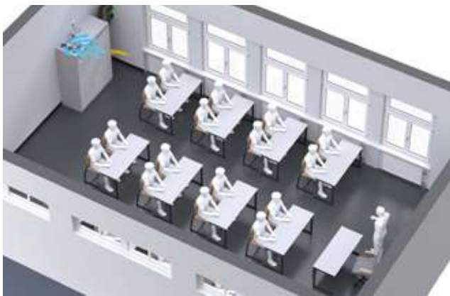
Abb. 2.7: Dezentrale Lüftungsgeräte sind im Raum installiert. Sie versorgen den Raum mit Frischluft und führen die Abluft nach außen ab. In den Geräten sorgen Systeme zur Wärme-, Kälte- und Feuchtigkeitsrückgewinnung für einen nachhaltigen Betrieb (Abbildung von Kampmann GmbH & Co. KG aus [5]).
